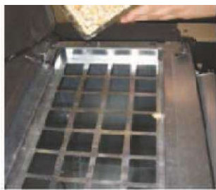
Фигура 8.1. Запълване на бункера с дървесни пелети.
