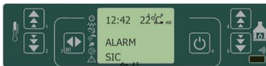
Фигура 7.6. Алармено съобщение при прегряване на камината.
