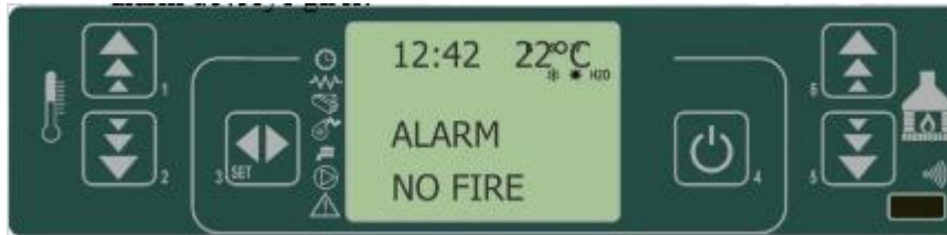
Фигура 7.3. Алармено съобщение при невъзможност за запалване.
