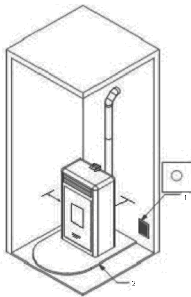
Фигура 3.1. Осигуряване на приток на въздух.
